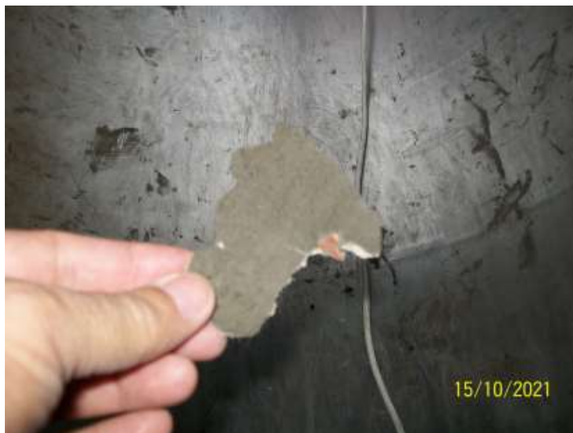
Fot.10,11. Fragmenty powłoki żywicznej z resztkami szpachłówki mineralnej.
